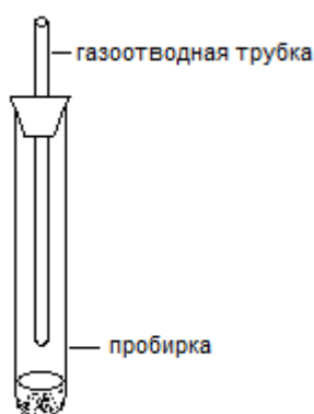
Рис. 15. Установка для получения метана из ацетата натрия
